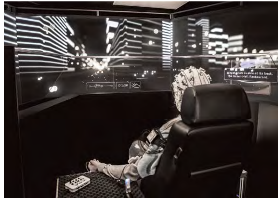
5 Probandin der EEG-Studie im eigens für das Experiment aufgebauten Fahrsimulator eines automatisierten Zukunftsfahrzeugs (Bildquelle: Audi)
